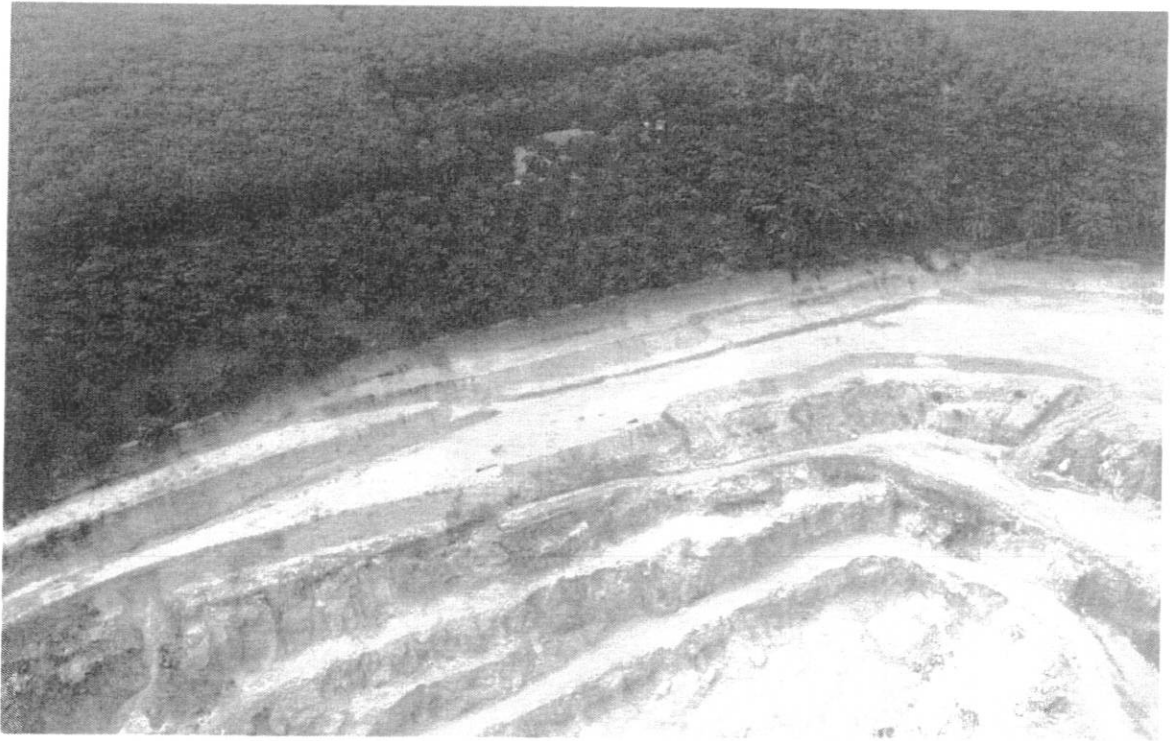
ภาพที่ 5 ขอบบ่อด้านทิศตะวันตก มีการถมปรับความลาดชันเพื่อความปลอดภัยของหน้าเหมืองสุดท้าย
